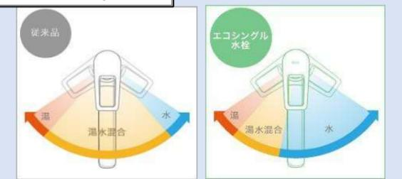
レバー操作による水と湯の使い分けがしやすく、お湯の無駄使いを防ぎます。(湯水の切替り時に「カチッ」と音がします。)
